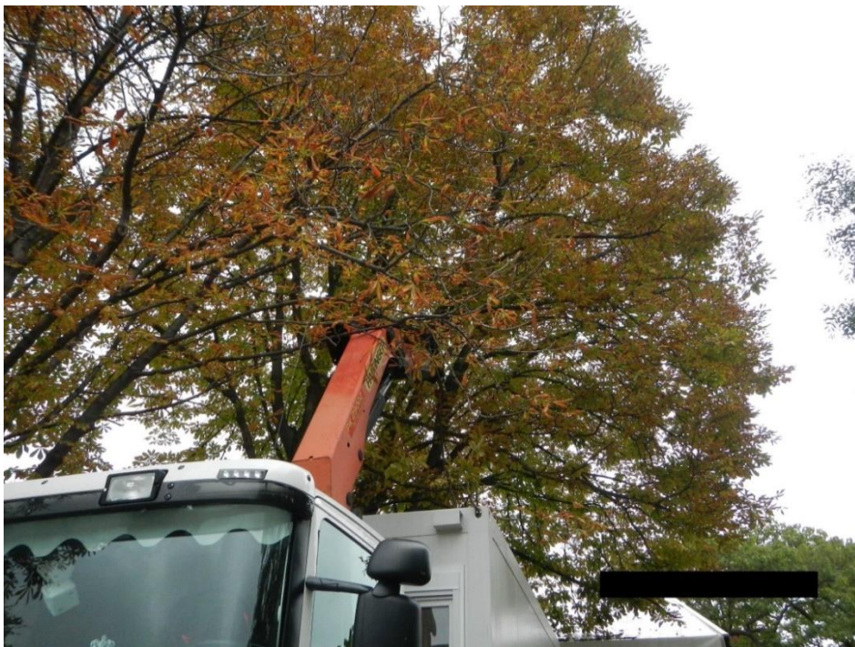
Abbildung 4: Eindringen eines Kranauslegers in eine Baumkrone
