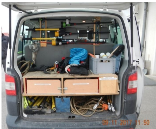
Abbildung 6: Ungeeignete Abtrennung zwischen Fahrgastraum und Laderaum
