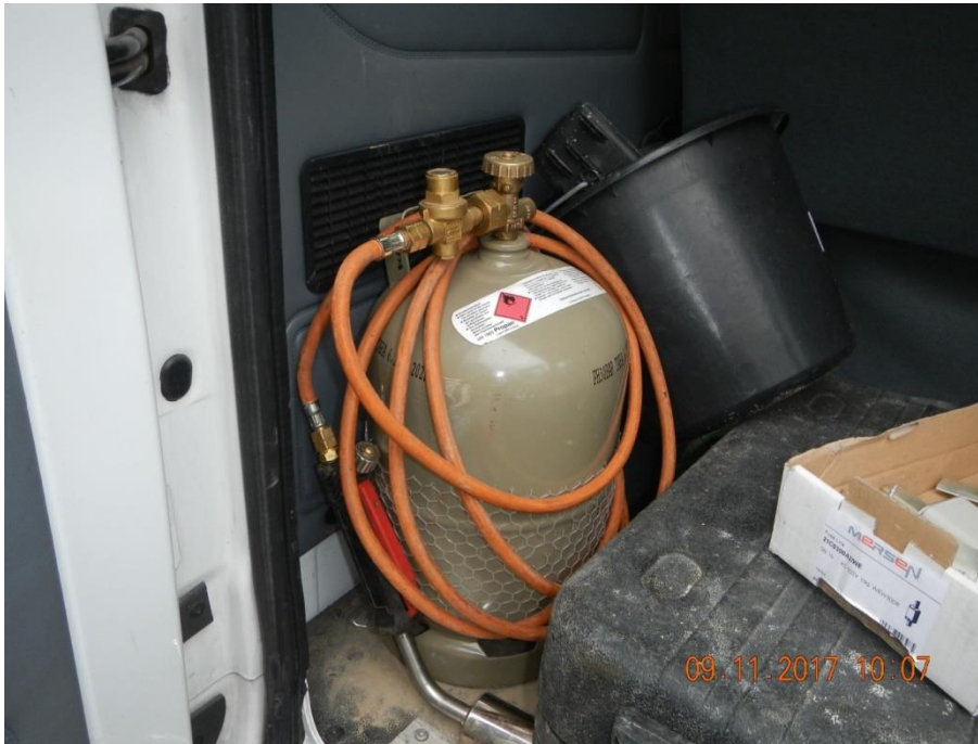
Abbildung 5: Ungesicherte Propangasflasche im Laderaum eines Transporters
