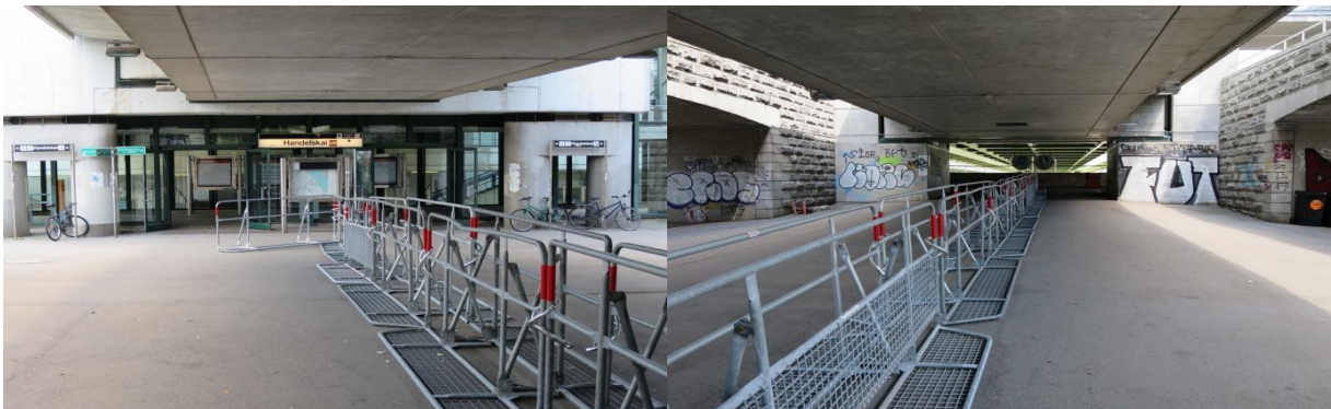
Abbildung 2 und 3: Trennung des Zu- und Abstroms
