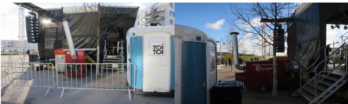
Abbildungen 14 und 15: Ölbefeuertes Heizaggregat
